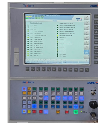
HMI mit 12" FS122 Touchscreen und MPo8 Maschinenpanel, alles kundenspezifisch in der SPS programmiert, einschliesslich der Visualisierungsbildschirme für die Programmierung und Bedienung
