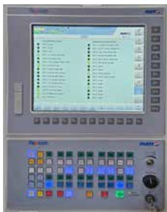
带有 MP08 机器面板的 HMI 12" FS122 触摸屏，所有程序均根据 PLC 逻辑定制，包括用于编程和操作的可视化屏幕。
