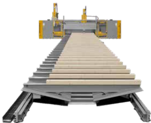
Essetre 和 NUM 合作的具體事例之一是 Techno Multiwall，這是一種用於加工大型木牆的 CNC 加工中心
