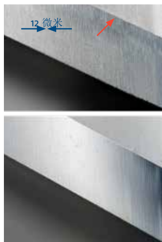
圖 3 第一個離隙角放大 200 倍的圖像，頂部為未修整的砂輪，底部為修整的砂輪
