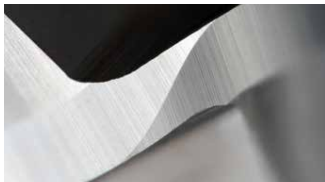
圖 1 橫向切削刃，使用 Keyence 數位顯微鏡測量（放大倍數 200:1）
