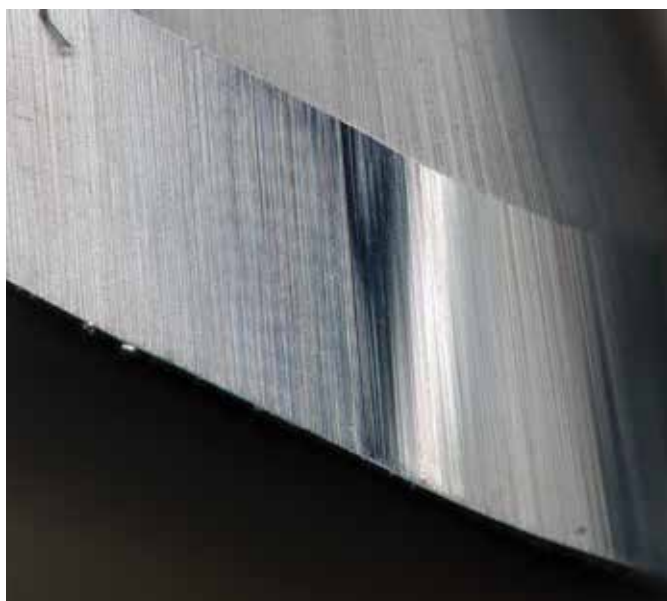
圖 4 使用 Keyence 數位顯微鏡在 200 倍放大下拍攝的半徑和圓柱之間的過渡，左側無可見痕跡，右側有可見痕跡
