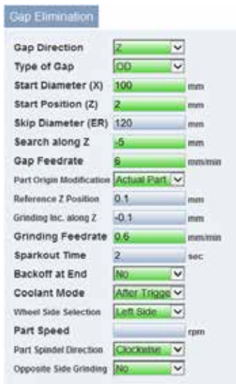
圖 5: 在 NUMgrind 人機介面中，間隙消除數據輸入畫面
