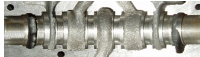
Un exemple typique de solution efficace d'un seul tenant offerte par Unimerco : un outil à rainurer les canaux et une pièce avant et après usinage
