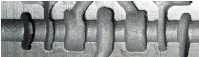
Un exemple typique de solution efficace d'un seul tenant offerte par Unimerco : un outil à rainurer les canaux et une pièce avant et après usinage
