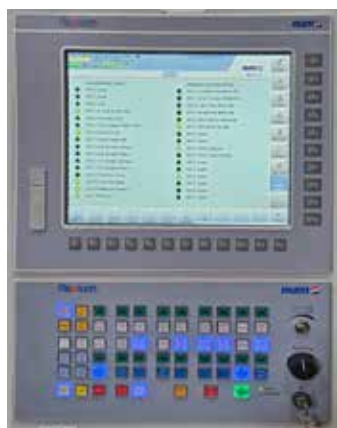
HMI 12 英寸 FS122 觸控螢幕與 MP08 機械面板，可在 PLC 邏輯中完成客製化，包括用於編程和操作的視覺化螢幕。
